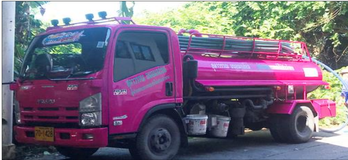
ภาพที่ 2-1 การดำเนินการสูบน้ำจากบ่อเกรอะ
